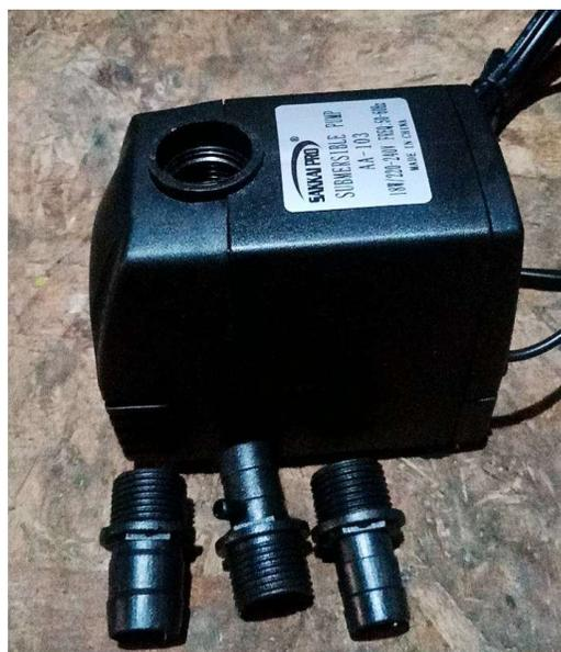
Gambar 7. Mesin pompa aquarium AA-103
