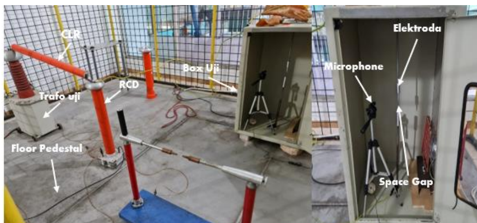
Gambar 4. Rancangan Bangun Perekaman Suara Corona Discharge Cubicle 20 kV
