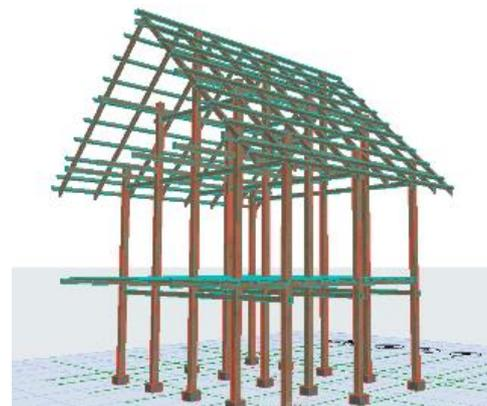
Gambar 9. Potongan Melintang Struktur Rumah Panggung dengan Archicad – Struktur bagian bawah
